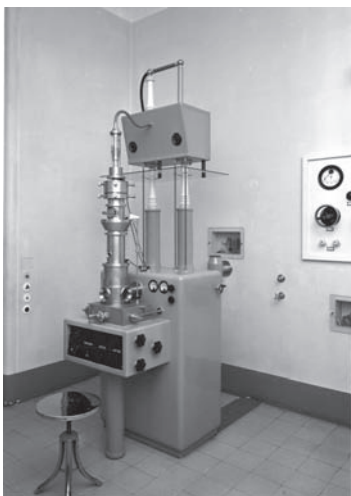
Figura 10. - Microscopio elettronico dell'ISS costruito nell'officina del Laboratorio di Fisica, 1946.
