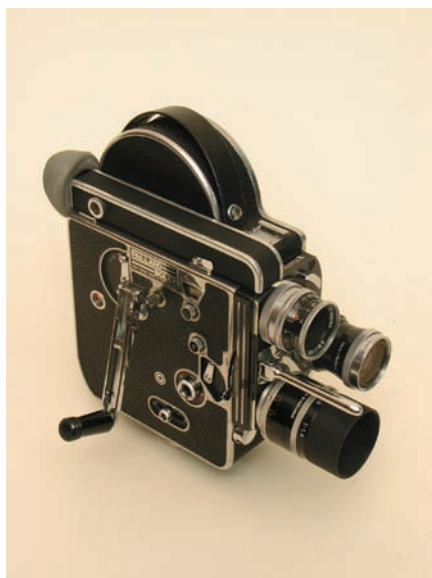
Figura 8. - Cinepresa Paillard Bolex a 16 millimetri con trascinamento meccanico. È corredata di 3 obiettivi montati in torretta, interscambiabili. Questo strumento, collegato a un microscopio ottico, è stato utilizzato per la realizzazione di filmati sulla crescita di colture cellulari.
