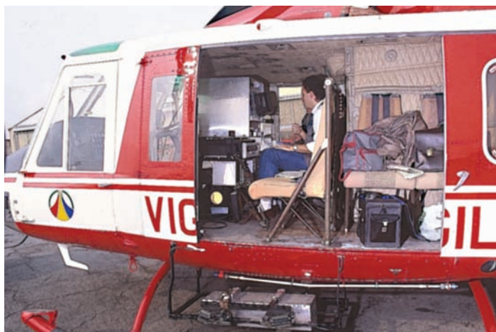
Figura 13. - Elicottero dei Vigili del Fuoco con lo strumento per il rilevamento delle sorgenti radioattive montato sotto la fusoliera.
