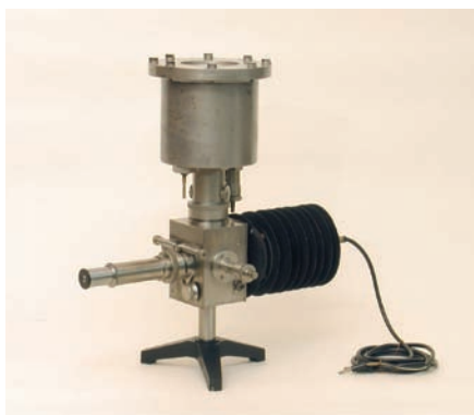
Figura 11. - Elettrometro di Lutz. Fu progettato dal prof. Giulio Cesare Trabacchi, direttore del Laboratorio di Fisica, apportando alcune modifiche agli elettrometri dello stesso tipo allora in uso. Costruttore: Istituto Superiore di Sanità, Roma. Provenienza: Laboratorio di Fisica, ISS (1941-2001). Datazione: 1942.
