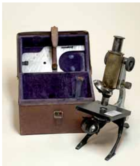
Microscopio composto Koristka a tre obiettivi portatile.
