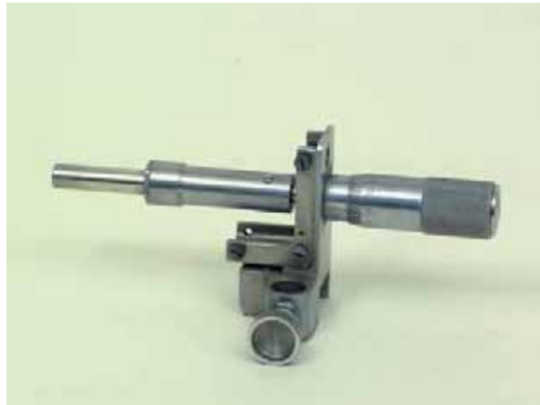
Prototipo di strumento con calibro a vite micrometrica.
