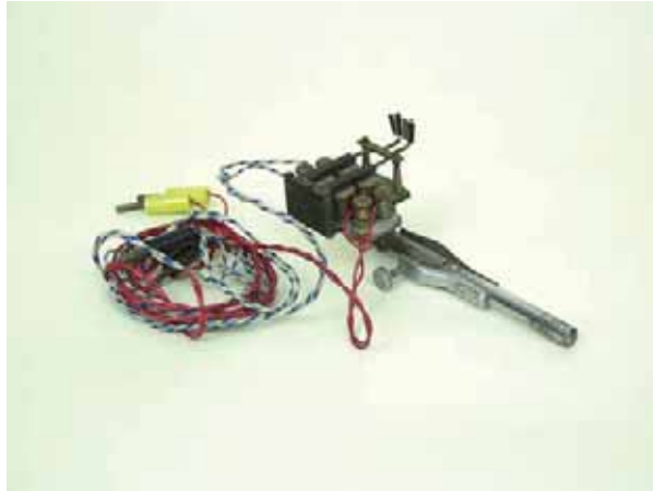
Marcatore elettrico di eventi per chimografi a carta affumicata.
