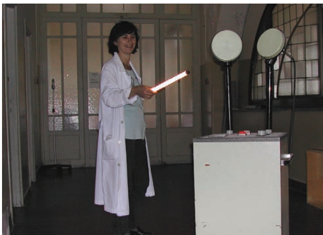
Figura 5 - Se il suo livello nell'ambiente è sufficientemente elevato, il campo elettromagnetico disperso nell'ambiente può innescare l'accensione spontanea di un tubo al neon
